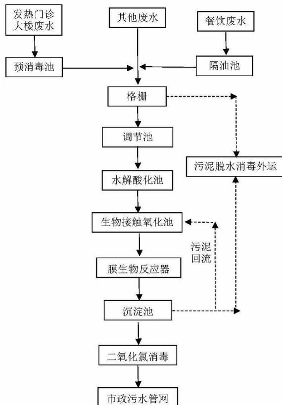
图 3.5-6 废水处理站工艺流程图
