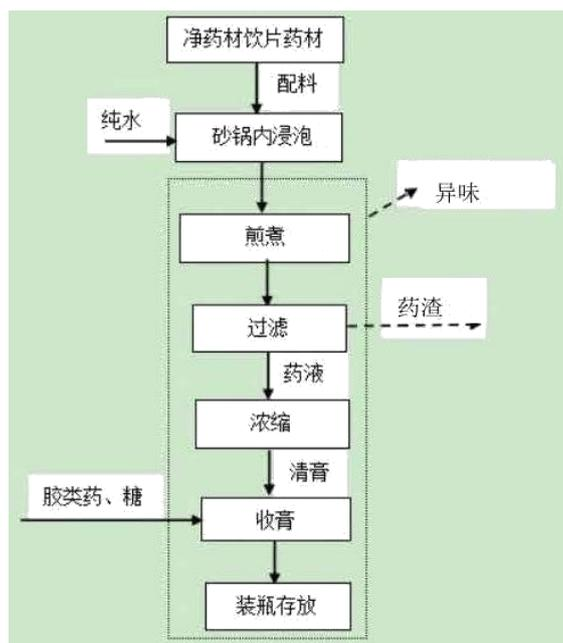
图 3.5-2 膏状制剂生产工艺流程及产污图
