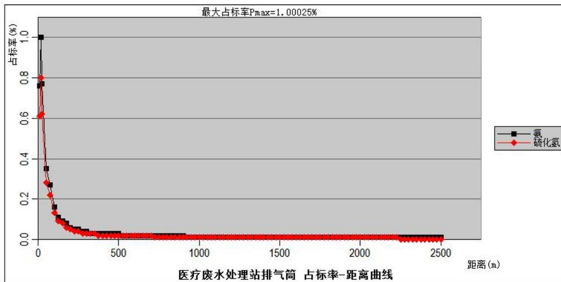
废水处理站排气筒中污染物最大地面浓度为氨的地面浓度  $0.002\text{mg}/\text{m}^3$ ，占标率为 1%；最大地面浓度出现的距离为下风向 17m 处。
