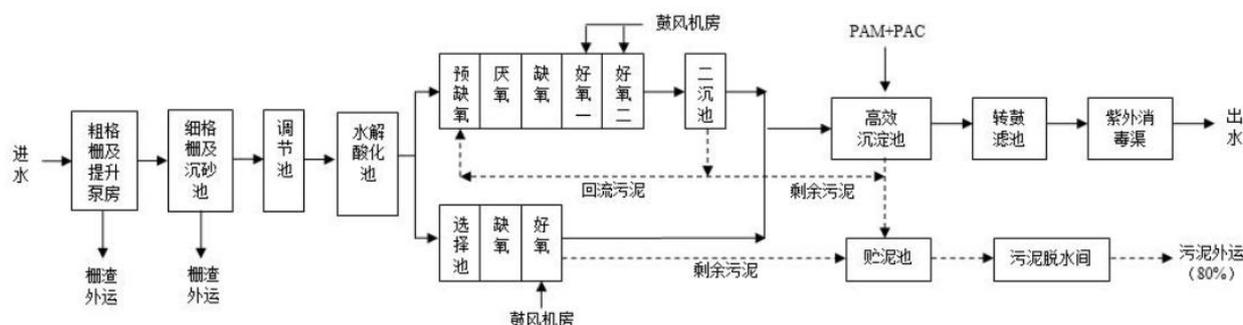
图 5.2-1 南充濠华高新技术产业园区污水处理厂处理工艺
