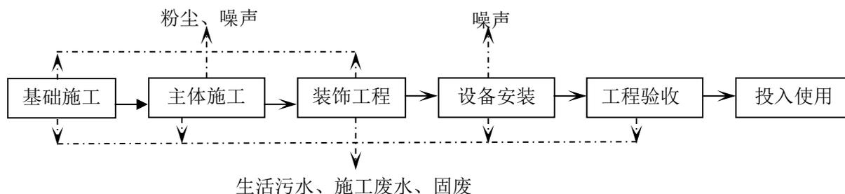
图 3.4-1 施工期工艺流程及产污情况
