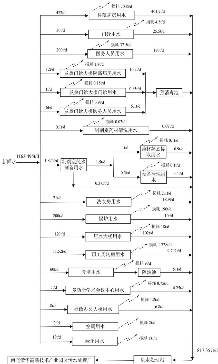
图 3.5-5 项目水平衡图
