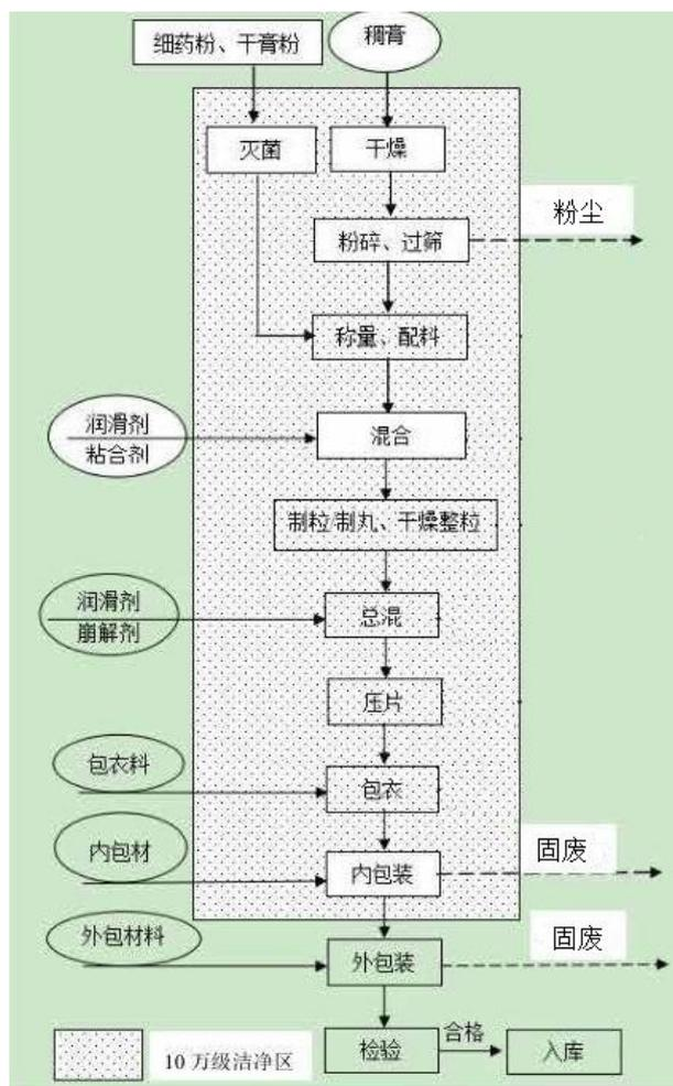
图 3.5-4 固体制剂生产工艺流程及产污图
