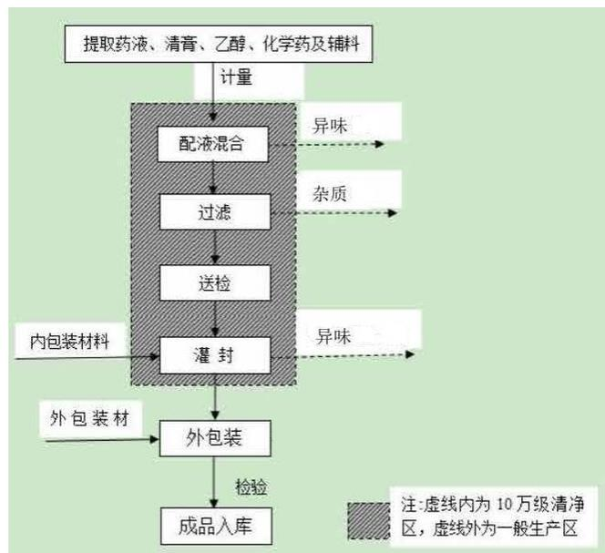
图 3.5-3 液体制剂生产工艺流程及产污图
