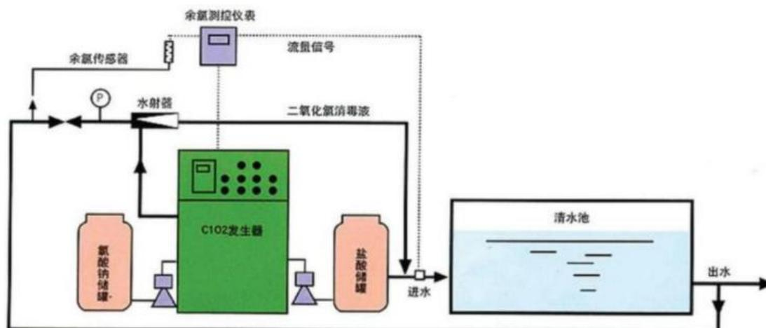
图 6.2-1 二氧化氯发生器工作原理图
